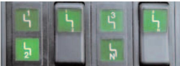
Die neue elektrohydraulische Schaltung gewährleistet ein komfortables Schalten per Tastendruck – und ein sicheres überdies, denn Fehlbedienungen sind damit absolut ausgeschlossen.
