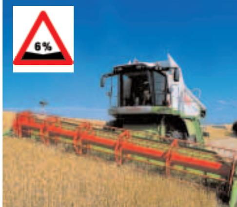
Bestleistung auch in der Schräglage. Der MONTANA gleicht bis zu 17 % seitliche Hangneigung automatisch aus und wird bei Fahrten bergauf und bergab vorn um bis zu 6 % angehoben oder abgesenkt.
